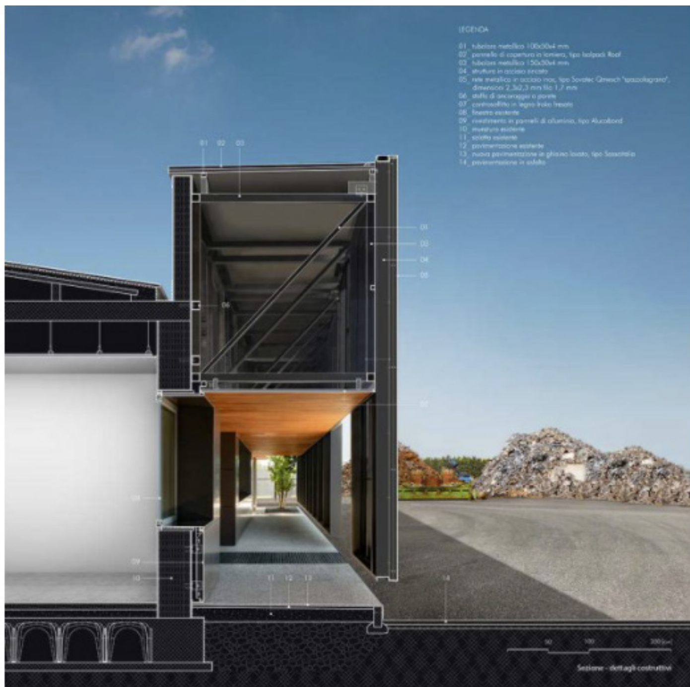
Sezione dei dettagli costruttivi
